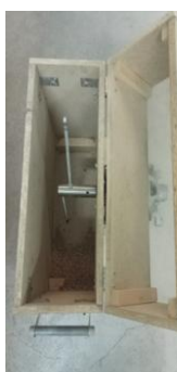
Рис. 2. Исследовательская установка для испытания образцов на абразивный износ Fig. 2. Research facility for testing samples for abrasive wear
