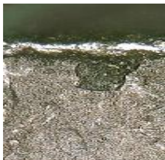
Рис. 5. Микрофотография поверхностного слоя образца после обработки кварцевым песком (фракция 0,25-0,31 мм) (увеличение x200 раз)
