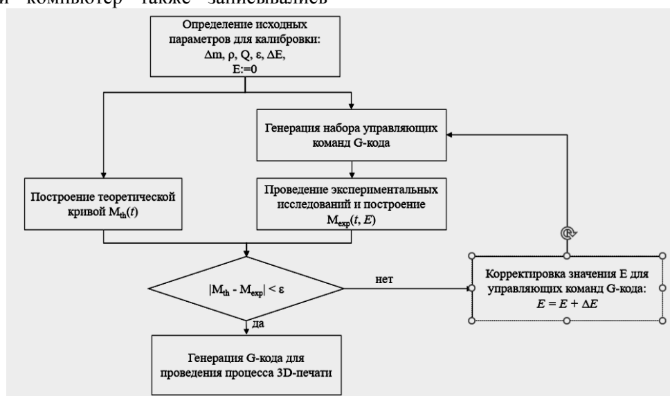
Рис. 4. Метод калибровки экструдера для вязких «чернил» Fig. 4. Extruder calibration method for viscous "ink"
