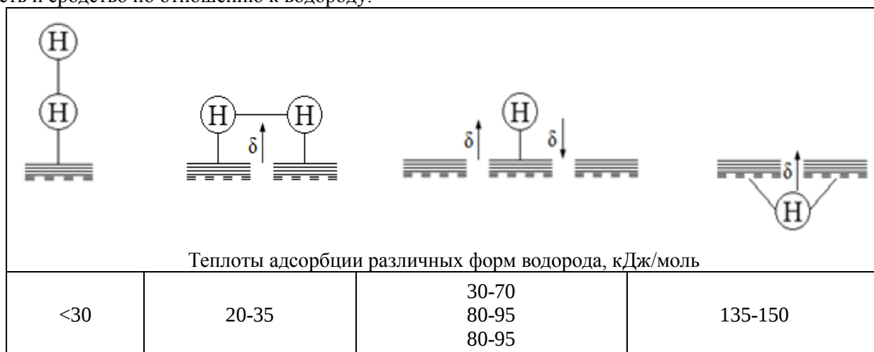
Рис. 1. Схема образования адсорбированного водорода на поверхности металла, по данным [26-28], где \uparrow\delta частичный перенос заряда
