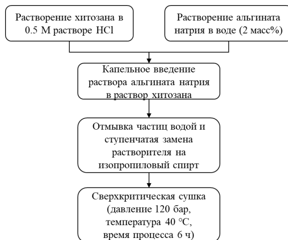
Рис. 1. Методика получения гибридных аэрогелей на основе полиэлектролитного комплекса альгинат-хитозан
