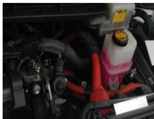
Рис. 7. Высоковольтные кабели Toyota Prius на шасси, а также в моторном отсеке Fig. 7. Toyota Prius high voltage cables on the chassis and also in the engine compartment
