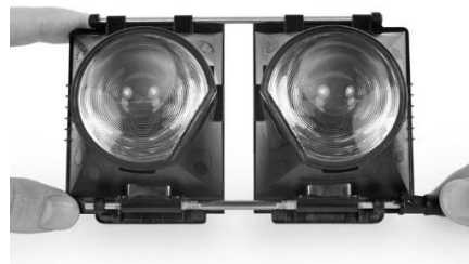
Рис. 4. Оптический модуль HTC Vive с линзами Френеля Fig. 4. HTC Vive Optical Module with Fresnel Lenses
