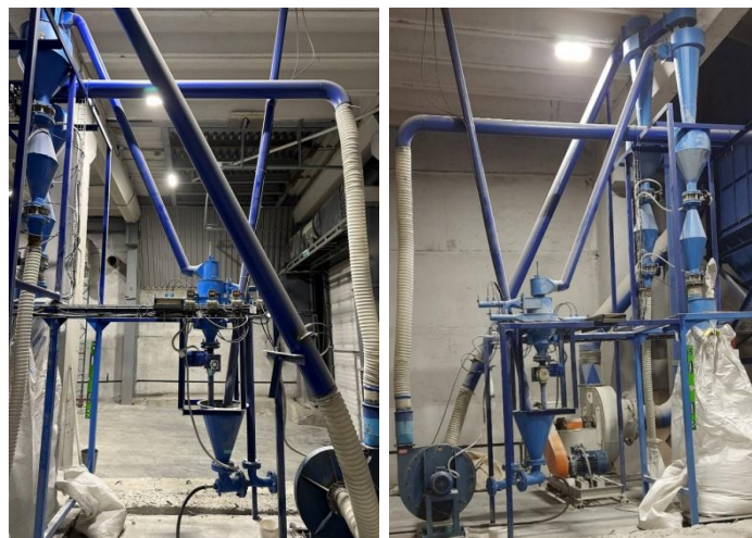
Рис. 5. Опытно промышленная установка эжекторной струйной мельницы с ударом в преграду производительностью 150 кг/ч Fig. 5. Pilot industrial installation of an ejector jet mill with an impact into an obstacle with a capacity of 150 kg/h
