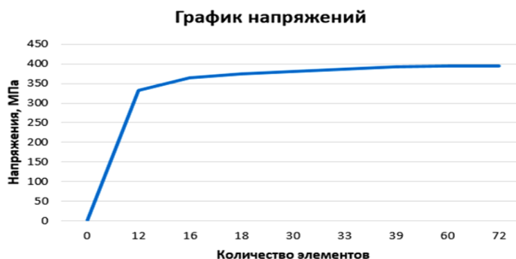
Рис.6. График зависимости максимального напряжения от количества элементов Fig.6. Graph of the dependence of the maximum stresses on the number of elements
