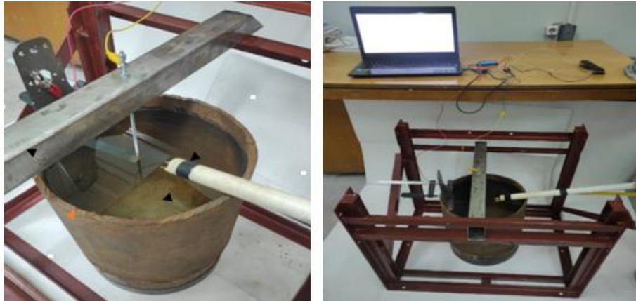
Рис 4. Экспериментальная установка: 1 – металлическая емкость; 2 – пластина; 3 – разрядник; 4 – электрод Fig. 4. Experimental setup: 1 – metal container; 2 – plate; 3 – spark gap; 4 – electrode
