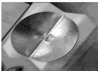
Рис. 7. Согнутая заготовка согласно CAD модели Fig. 7. Bent blank according to CAD model
