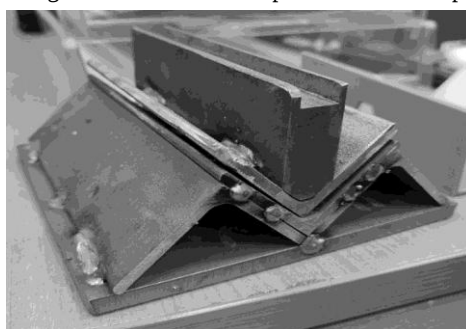
Рис 2. Тестовые пуансон и матрица V образной формы изготовленные из стали С235 Fig 2. Test punch and V-shaped die made of C235 steel
