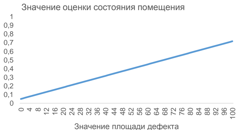
Рис. 1. Зависимость оценки состояния помещения от изменения площади одного дефекта Fig. 1. The dependence of the assessment of the condition of the room on the change in the area of one defect
