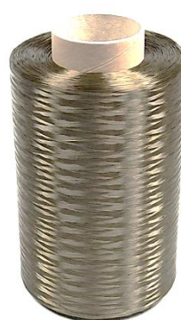
Рис. 2. Базальтовое волокно БНВ Fig. 2. Basalt fibre BCF
