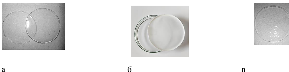
Рис. 1. Внешний вид модифицированных полимерных пленок на основе ДАЦ: а – 1E3MiMAc; б – 1E3MiMBr; в – 1E3MiMTFMS Rice. 1. Appearance of modified DAC-based polymer films: a — 1E3MiMAc; b — 1E3MiMBr; c — 1E3MiMTFMS
