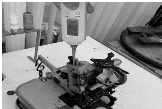
Рис. 2. Измерение вибрационных характеристик краеобметочной машины GN-1 Fig. 2. Measuring the vibration characteristics of the GN-1 edge overcasting machine
