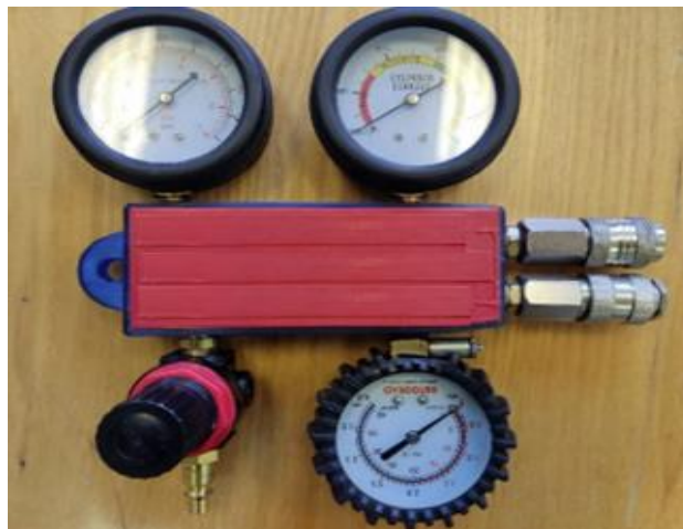
Рис.1. Прибор для диагностики двигателей Fig. 1. Device for engine diagnostics
