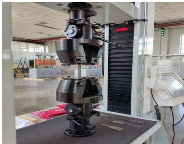
Рис.2. Разрывная машина УТС-111.2-5-22 Fig.2. Tearing machine UTS-111.2-5-22
