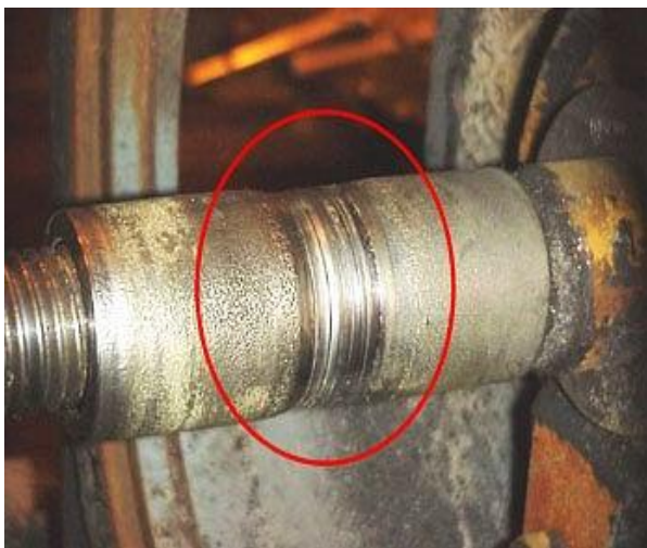
Рис. 2. Изношенный участок вала под манжетное уплотнение Fig. 2. Worn section of the shaft under the lip seal
