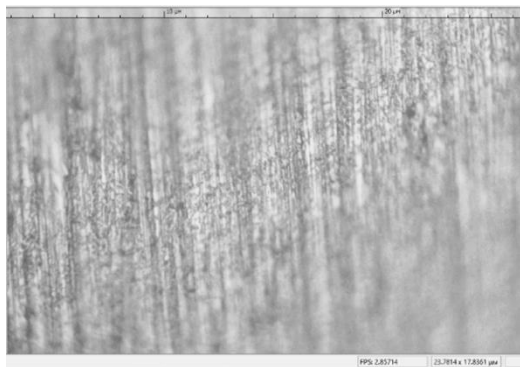
Рис. 6. Состояние поверхности после машинной притирки Fig. 6. Surface condition after machine lapping
