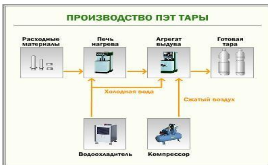
Рис. 1. Технологическая схема процесса производства ПЭТ- бутылок
