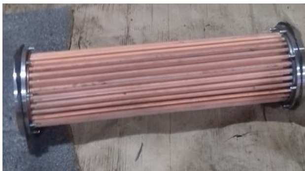
Рис.2. Фотография трубчатого мембранного элемента опытно-промышленной установки Fig. 2. Photo of a tubular membrane element of a pilot plant
